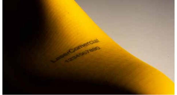
Ces machines intègrent un laser à fibre et une technologie de contrôle "Galvo" pour marquer tous les types de métaux et de plastiques à une vitesse impressionnante. Le marquage laser atteint des vitesses de marquage incroyables grâce à la technologie Galvo. Contrairement à la technologie CNC, la tête du laser ne doit pas être positionnée à l'endroit où l'on veut marquer.
