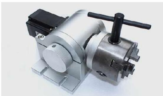
**Zubehör zum korrekten Markieren zylindrischer Objekte**
